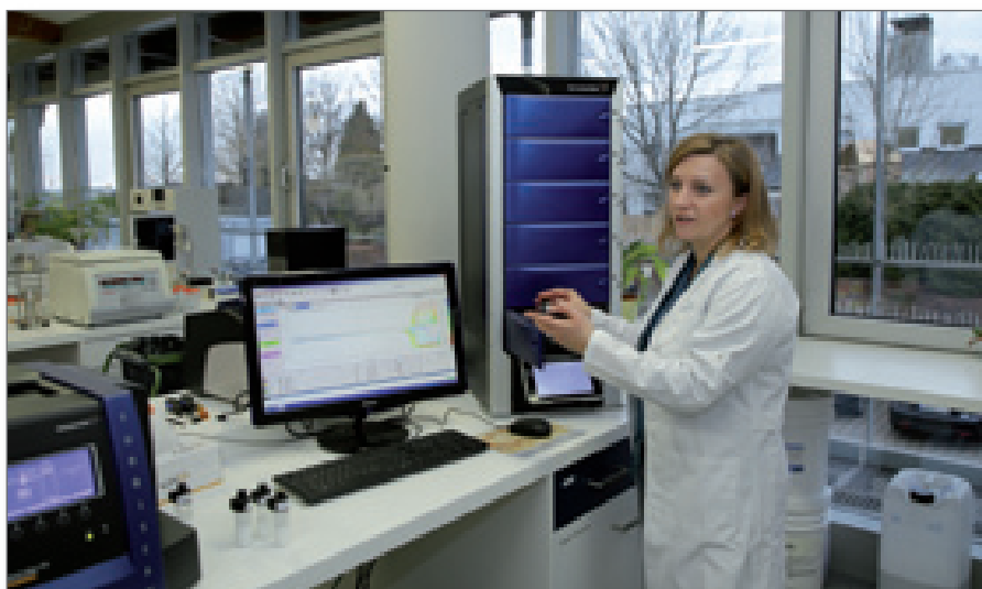
Abbildung 1 Blick in unser Dispersionslabor: Frau Eikelmann bei der Erläuterung von Stabilitätsuntersuchungen originaler Emulsionen am TURBISCAN TOWER
