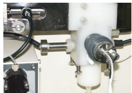
Abbildung 1 Verwendetes Messgerät DT-1200 zur Partikelgrößenanalyse mittels akustischer Dämpfung (oben) und Abbildung 2 zur Bestimmung des Zetapotenzials mittels elektroakustischer Sonde (unten)
