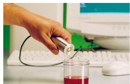
Abbildung 1 Verwendetes Messgerät DT-1200 zur Partikelgrößenanalyse mittels akustischer Dämpfung (oben) und Abbildung 2 zur Bestimmung des Zetapotenzials mittels elektroakustischer Sonde (unten)
