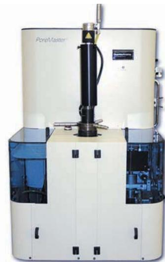
Abbildung 7 Messgerät POREMASTER
