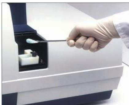
Abbildung 3 CILAS 1180LD mit Trockendispergierung
