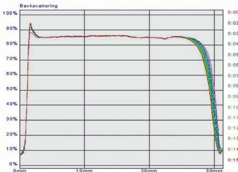
Abbildung 3 15-minütige Turbiscan Messung einer wässrigen Titandioxidsuspension
