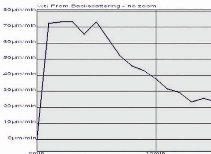
Abbildung 5 Errechnete Migrationsgeschwindigkeiten im oberen Bereich der Titandioxidsuspension
