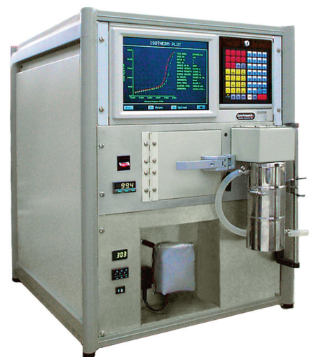
Abbildung 2 HYDROSORB 1000 HT mit einem Messbereich von 12°C – 85 °C bis zu jeweils hohen relativen Feuchten
