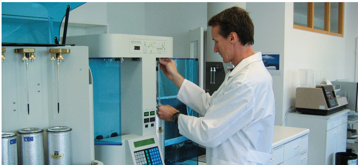
Abbildung 2 Messgeräte NOVAe und QUADRASORB SI im Labor für wissenschaftliche Partikelanalyse (LabSPA) im Einsatz zur Oberflächen- und Porenanalyse.
