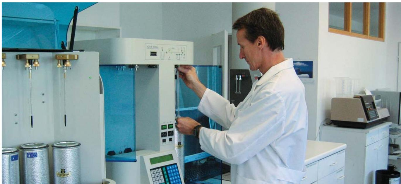
Abbildung 2 Messgeräte NOVAe und QUADRASORB SI im Labor für wissenschaftliche Partikelanalyse (LabSPA) im Einsatz zur Oberflächen- und Porenanalyse.
