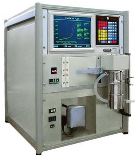
Abbildung 2 HYDROSORB 1000 HT mit einem Messbereich von 12°C – 85 °C bis zu jeweils hohen relativen Feuchten
