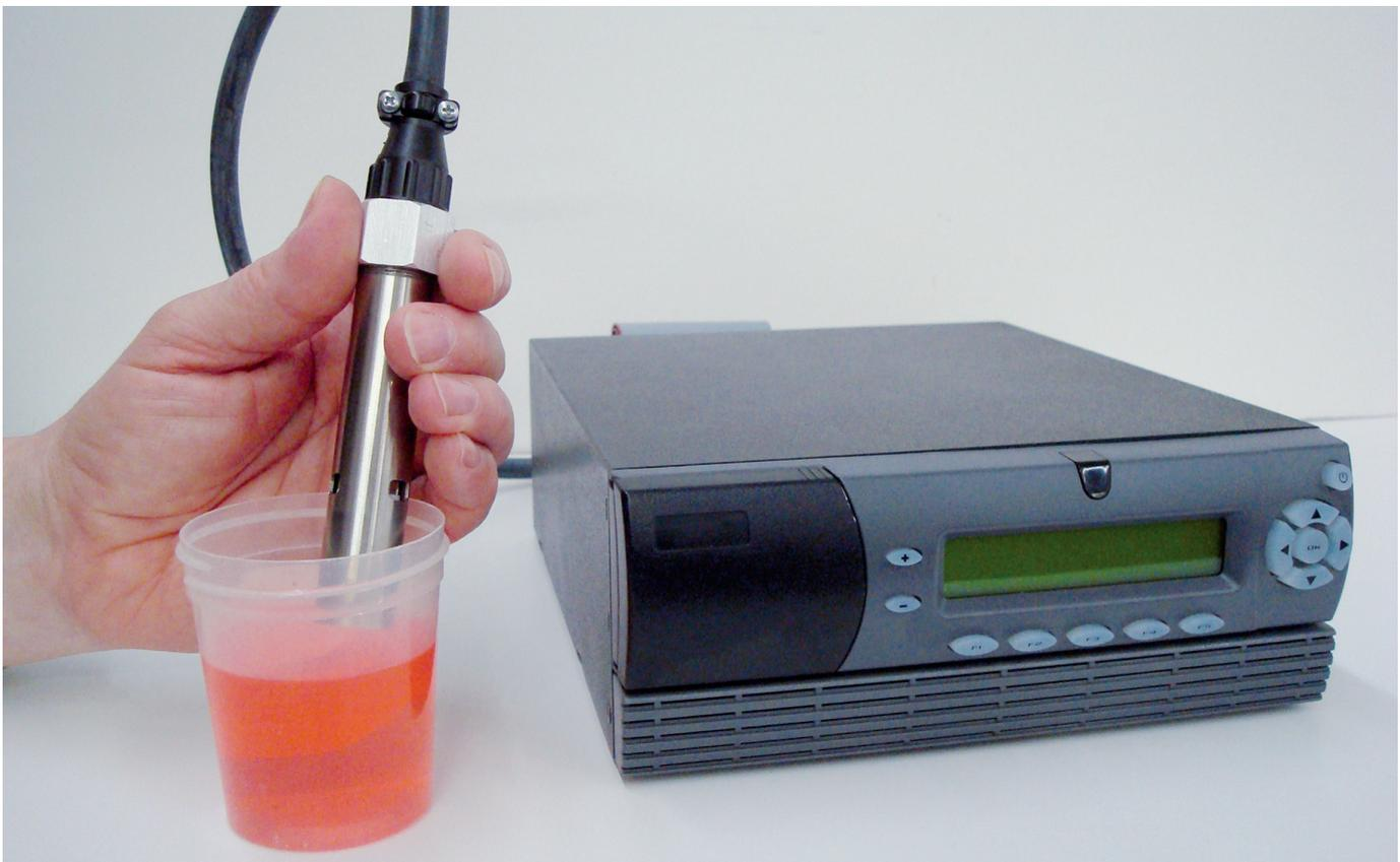
Abbildung Neu: Sonde DT-700 zur Messung der Leitfähigkeit nichtwässriger Flüssigkeiten/Dispersionen über einen Messbereich von reinem Toluol bis zu destilliertem Wasser
