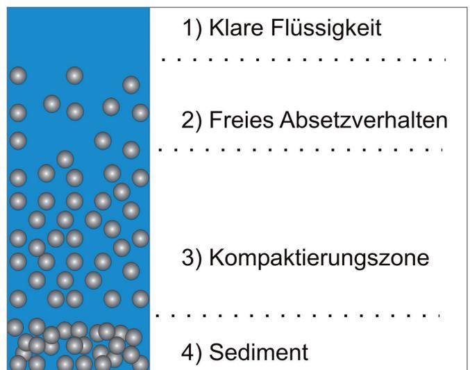
Abbildung 3 Schematische Darstellung der Sedimentation mit den unterschiedlichen Bereichen bei ungehinderter Sedimentation [5]
