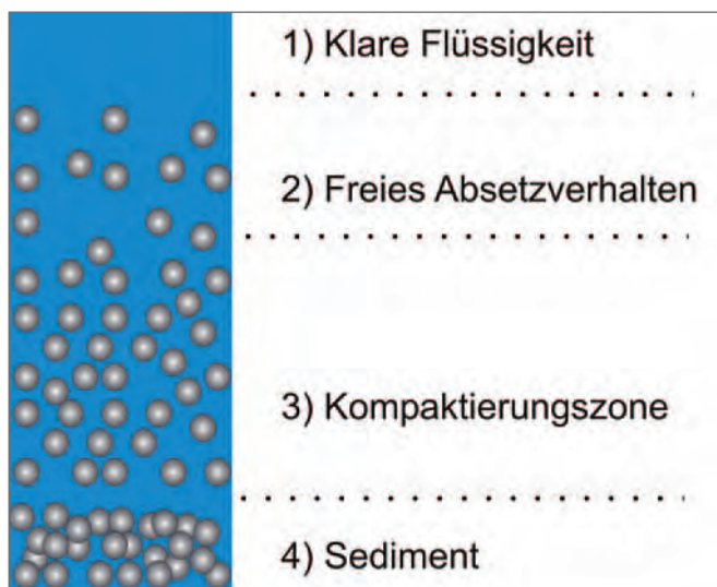
Abbildung 3 Schematische Darstellung der Sedimentation mit den unterschiedlichen Bereichen bei ungehinderter Sedimentation [5]
