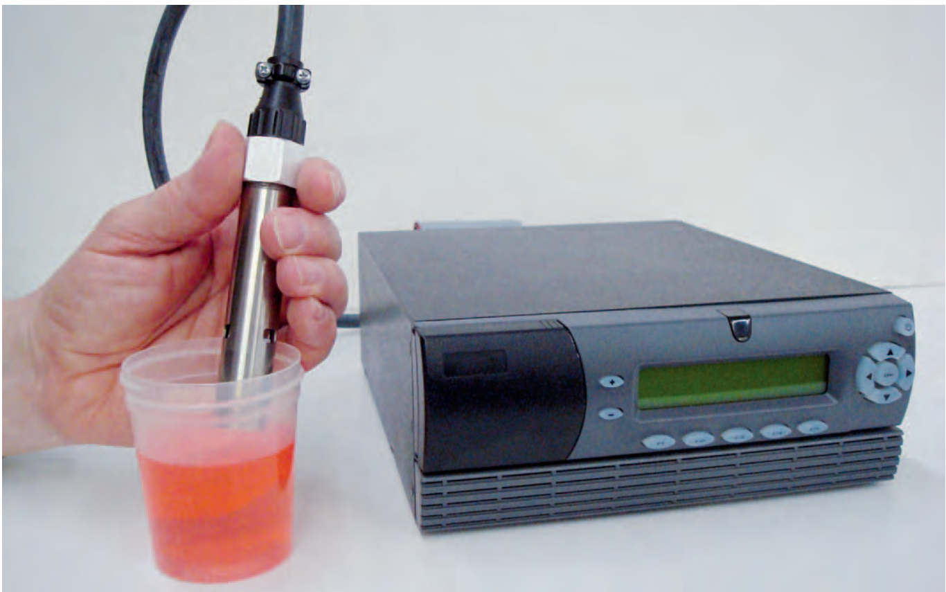
Abbildung Neu: Sonde DT-700 zur Messung der Leitfähigkeit nichtwässriger Flüssigkeiten/Dispersionen über einen Messbereich von reinem Toluol bis zu destilliertem Wasser
