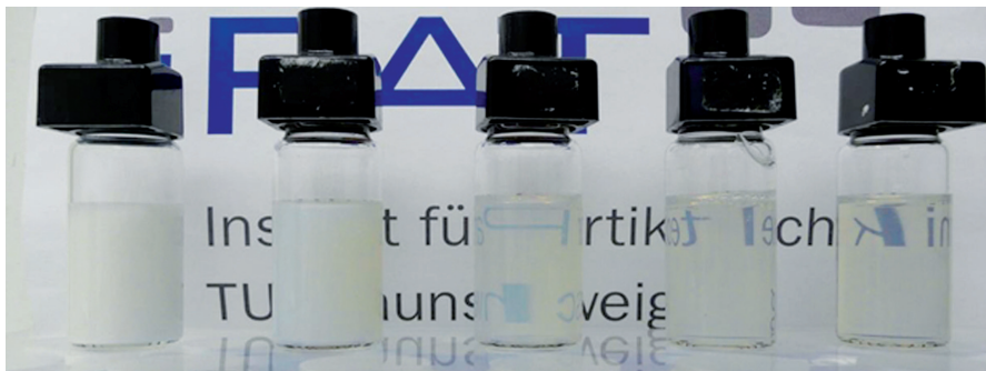
Abbildung 4 Fotos der Suspensionen nach 46.000 kJ/kg, 100.000 kJ/kg, 158.000 kJ/kg und 198.000 kJ/kg spezifischen Energieeintrag für d_{MK} = 200 \mu\text{m} und v_t = 4 \text{ m/s}
