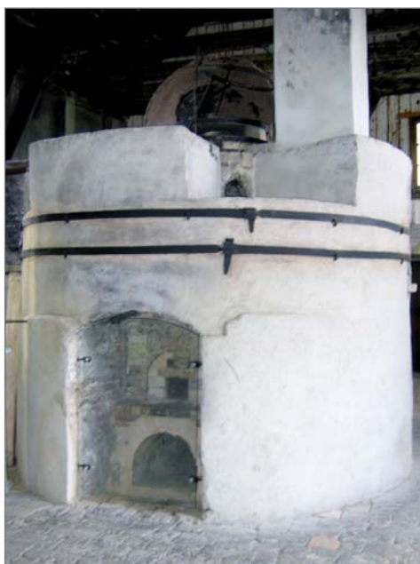
Abbildung 4 Historischer Glasschmelzofen, in dem Joseph Fraunhofer das seinerzeit reinste optische Glas herstellte
