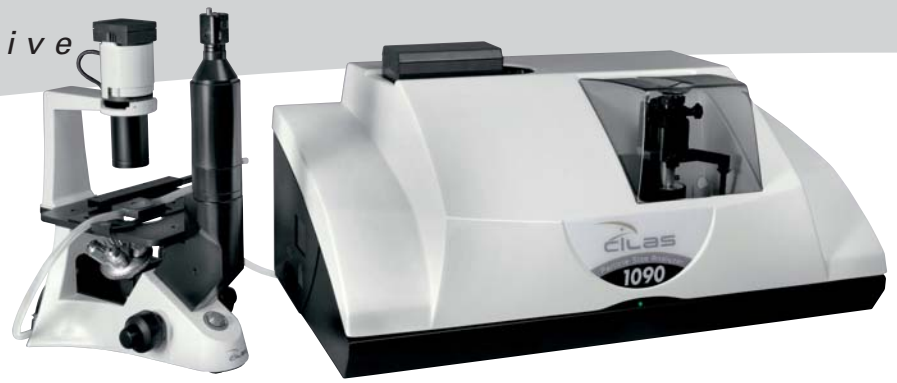
Abbildung 6 Laserbeugung nach Fraunhofer (und Mie) mit dem CILAS-Lasergranulometer 1090LD und EXPERT SHAPE zur ergänzenden Partikelformanalyse
