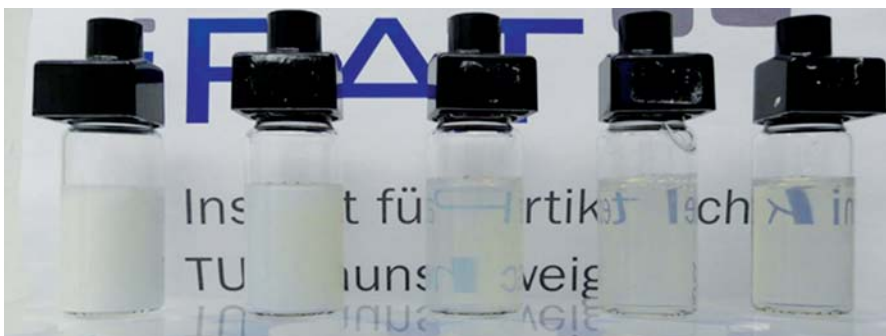
Abbildung 4 Fotos der Suspensionen nach 46.000 kJ/kg, 100.000 kJ/kg, 158.000 kJ/kg und 198.000 kJ/kg spezifischen Energieeintrag für d_{MK} = 200 \mu\text{m} und v_t = 4 \text{ m/s}
