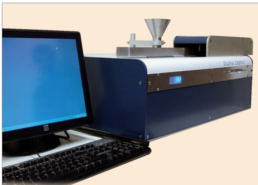
Abbildung 2 OCCHIO ZEPHYR für die Partikelgrößen- und Partikelformanalyse von Grobputz mit Partikeldurchmessern von 20 µm bis 30 mm
