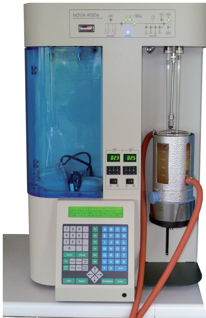
Abbildung 5 QUANTACHROME NOVA 4200e zur Parallelbestimmung von vier CO_2 -Isothermen bei 273 K mit einem Kältehermostaten
