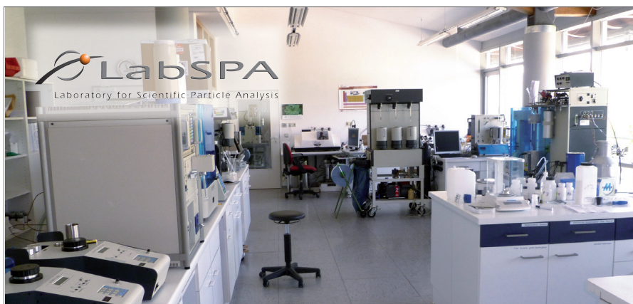
Abbildung 1 Ein Blick in das LabSPA: Messgeräte zur Oberflächen- und Porenanalyse mit Blick in Richtung Laserbeugungsstrecke zur Partikelgrößen- und formanalyse
