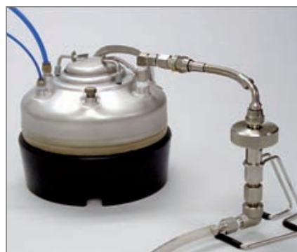
Abbildung 8 Option zur Bestimmung der Flüssigkeitspermeabilität mit der POROMETER 3G-Serie: Flüssigkeitsbehälter (links), geschlossener Probenhalter (rechts) und im Kreislauf geführte Flüssigkeitsdruckleitung
