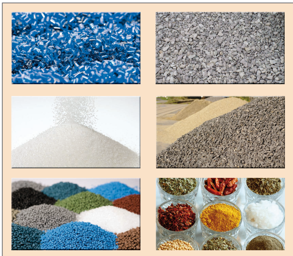
Abbildung 2 Pulver, Granulate und Schüttgüter als mögliche Proben zur Partikelcharakterisierung mit dem ZEPHYR ESR (von links nach rechts, von oben nach unten: geschredderter Kunststoff, feiner Schotter, Zucker, verschiedene Pellets, Kunststoffgranulat, Gewürze bzw. geschnittene Pflanzenteile)
