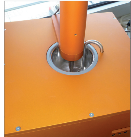
Abbildung 3 DISPERSER QC2 – die externe Dispergiereinheit mit integriertem Rührer, Ultraschallbad und Umpumpsystem ist im Prinzip mit allen Messgeräten zur Analyse von Suspensionen kombinierbar, Vorderansicht (unten) mit Schlauchpumpe, Display und Bedienknöpfen sowie Draufsicht (oben) mit Ultraschallbad und Rühreinheit
