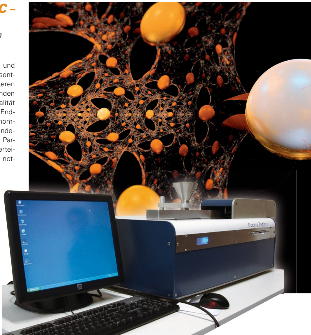
Abbildung 1 ZEPHYR-Analysegerät zur Bestimmung von Partikelgrößen- und Partikelformverteilung von Schüttgütern (Granulate und Pulver) durch vollautomatische Bildanalyse
