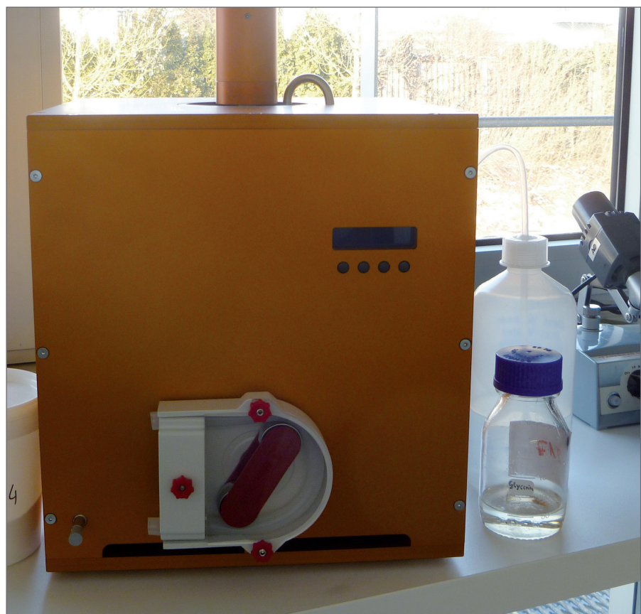
Abbildung 3 DISPERSER QC2 – die externe Dispergiereinheit mit integriertem Rührer, Ultraschallbad und Umpumpsystem ist im Prinzip mit allen Messgeräten zur Analyse von Suspensionen kombinierbar, Vorderansicht (unten) mit Schlauchpumpe, Display und Bedienknöpfen sowie Draufsicht (oben) mit Ultraschallbad und Rühreinheit
