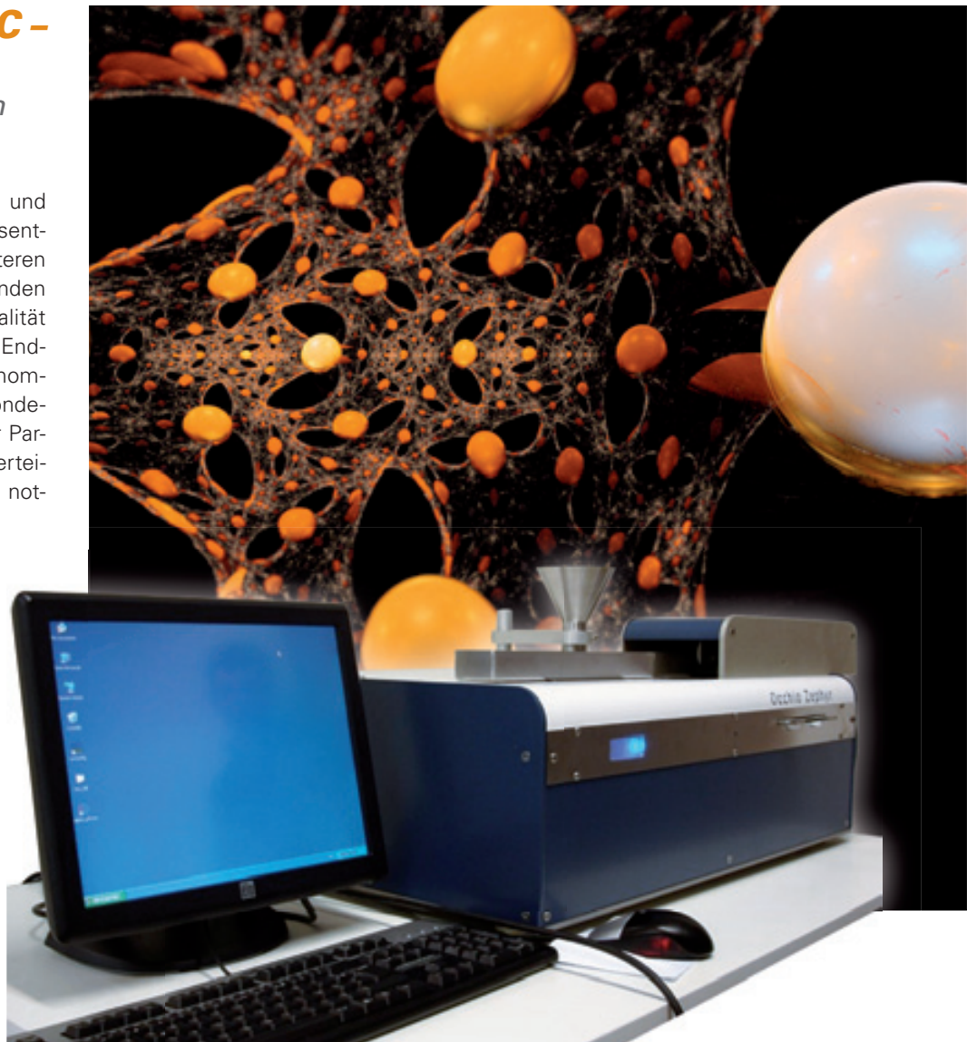
Abbildung 1 ZEPHYR-Analysegerät zur Bestimmung von Partikelgrößen- und Partikelformverteilung von Schüttgütern (Granulate und Pulver) durch vollautomatische Bildanalyse
