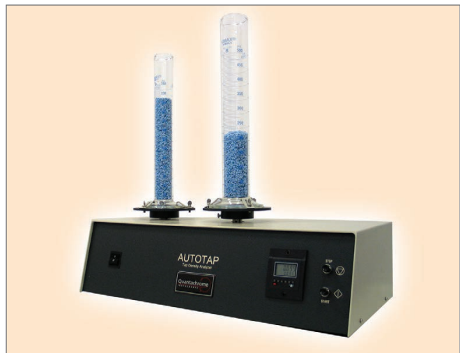
Abbildung 4 Einfach, reproduzierbar und praxisnah – das AUTOTAP ist für die Bestimmung von Schütt- und Stampfdichten gleichermaßen geeignet. Als Ein- oder Zweistationengerät, mit unterschiedlichen Messzylindern und einstellbarer Klopfzahl können verschiedenste Probenarten untersucht werden.
