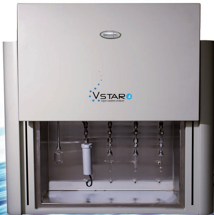
Abbildung 4 VSTAR mit 4 Messstationen vor dem Start einer Messung. Links ist die Zelle für die zu vermessende Flüssigkeit zu erkennen (deren Dampf das Adsorptiv ist), daneben eine Probenzelle, die bereits am Thermostat angeschlossen ist, die anderen 3 Probenzellen sind noch ohne Thermostatanschluss
