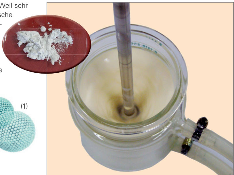
Abbildung 1 Herstellung der stabilen \text{Ca}(\text{OH})_2 Suspension. links: Ausgangspulver; rechts: fertige Dispersion
