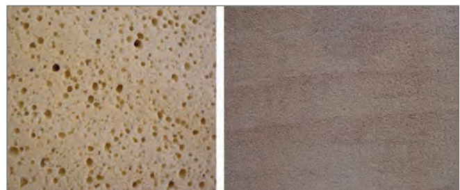
Abbildung 7 Bestimmung von geschlossenen Poren über Dichtemessung mit dem ULTRAPYC 1200eT vor und nach Mahlung mit der MillPrep: offenporige Schaumstruktur (links) und offen- und geschlossenenporige Struktur (Baustoff, rechts)
