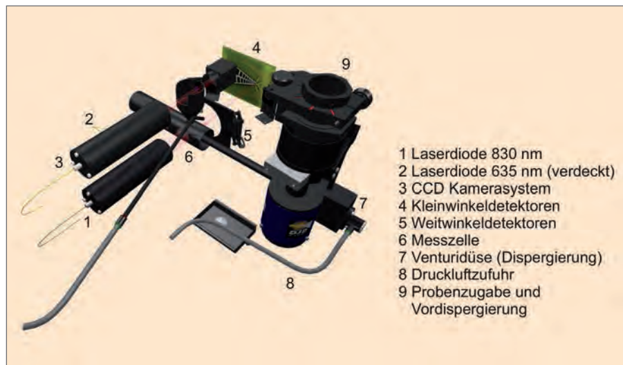
Abbildung 5 Aufbau der Trockendisdispergiereinheit der CILAS-Laserbeugungsgeräte
