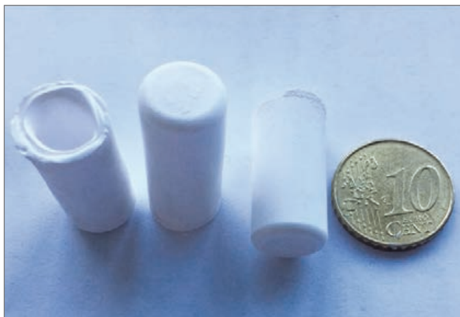
Abbildung 8 Isolierte Grünkörper A (links) und B (rechts)
