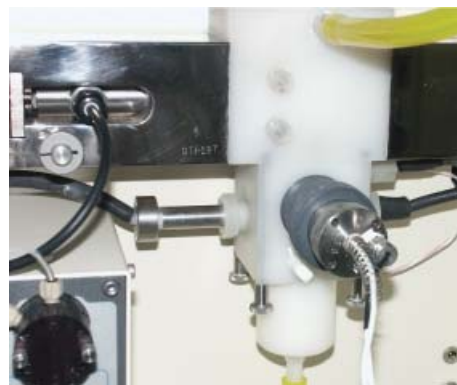
Abb.1 Zetapotentialsonde von DISPERSION TECHNOLOGY (DT-300 sowie integriert im DT-1200): flexible Zetapotentialbestimmung in konzentrierten Emulsionen und Dispersionen, Messung im Labor und On-line, auch im flow, benötigte Probenmenge: 5 ml
