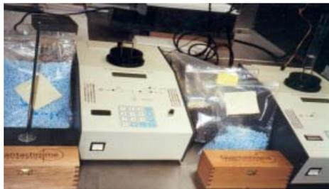
**Abb. 2** ULTRAPYCNO-METER 1000T zur Dichtemessung und ULTRAFOAMPYCNO-METER-T zur Prüfung von Kunststoffschäumen
