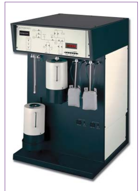
Abbildung 2 AUTOSORB-1-MP für hochauflösende Gassorptionsmessungen
