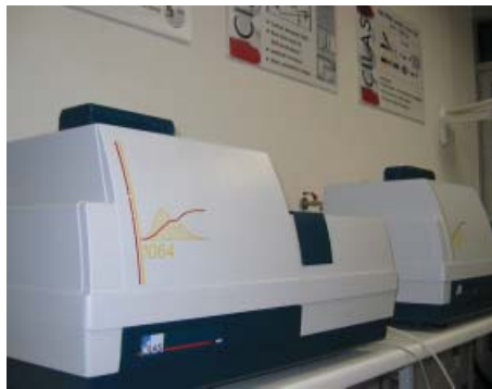
Abbildung 3 CILAS-Lasergranulometer im Einsatz: Genau, reproduzierbar, robust und platzsparend
