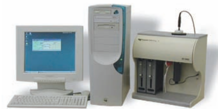
Spektrometer DT-1200 zur Zetapotenzial- und Partikelgrößenbestimmung in konzentrierten Dispersionen
