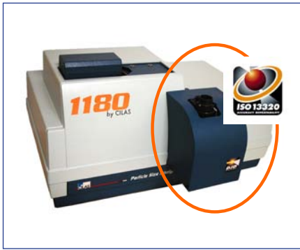
Abbildung 9 Das innovative CILAS-Konzept für die Trockendispergierung: Die neue DJD
